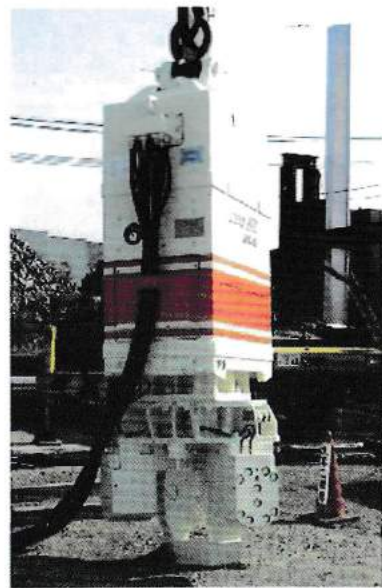
固定装置安装图(帽型钢板桩900专用)
